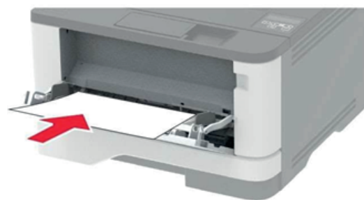
Рисунок 28 – Загрузка бумаги в многоцелевое устройство подачи.
