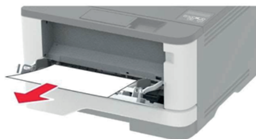
Рисунок 21 – Извлечение замятой бумаги из многоцелевого устройства подачи.
