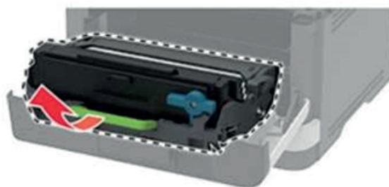
Рисунок 8 – Извлечение блока формирования изображения.
