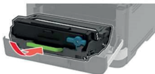
Рисунок 7 – Установка блока формирования изображения в МФУ.
