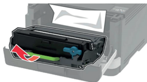
Рисунок 31 – Извлечение блока формирования изображения.
