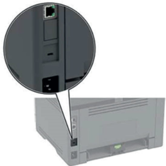
Рисунок 15 – Расположение гнезда секретного замка безопасности.
