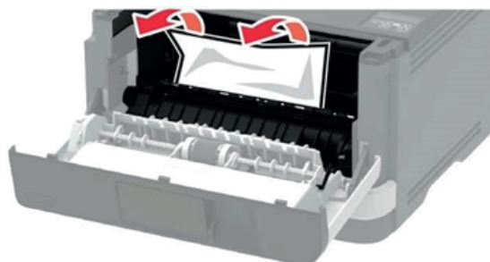
Рисунок 25 – Извлечение замятой бумаги из многоцелевого устройства подачи.
