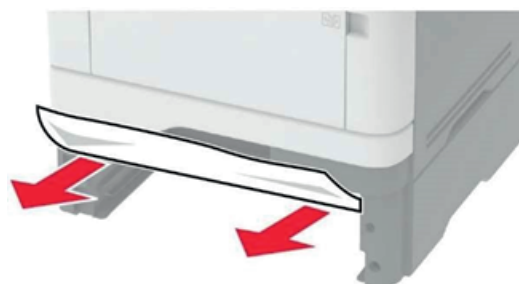
Рисунок 36 – Извлечение замятой бумаги.
