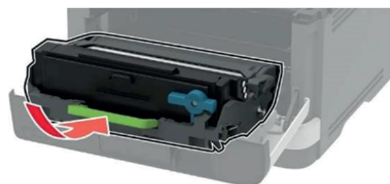
Рисунок 26 – Установка блока формирования изображения.
